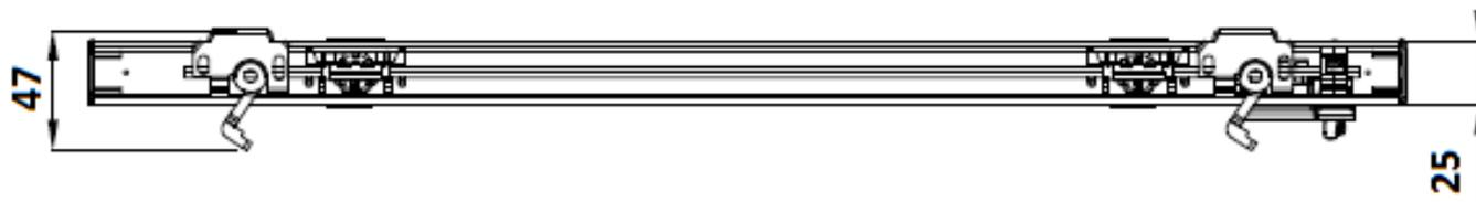
Détail guidage câble latéral en acier gainé + équerre avec serre-câble: Option avec plus-value.
