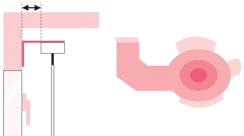
Fixer le support plafond puis placer le rail en dessous. Le verrouillage s'effectue par rotation avec le support.
